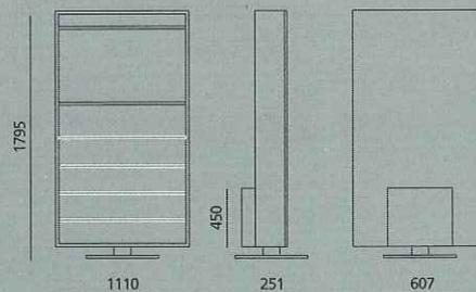
Basamento in metallo con finitura satinata. Struttura in tubolare nera. Anta in vetro montata su telaio in alluminio anodizzato nero. Schiena a specchio montata su telaio in alluminio anodizzato nero.
