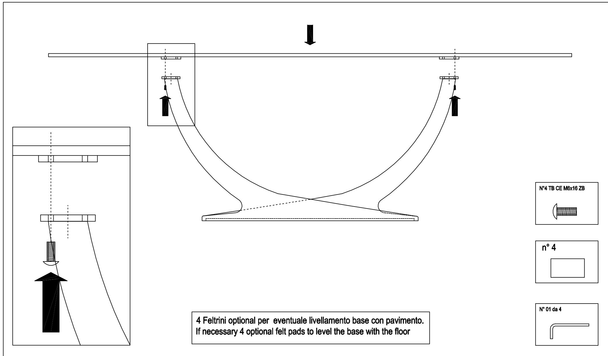
**ATTENZIONE:**E' normale che si presenti una situazione come in figura tra le piastre. IMPORTANTISSIMO non cercare di colmare l'aria presente. MAI eccedere nel tiraggio delle viti di fissaggio.
