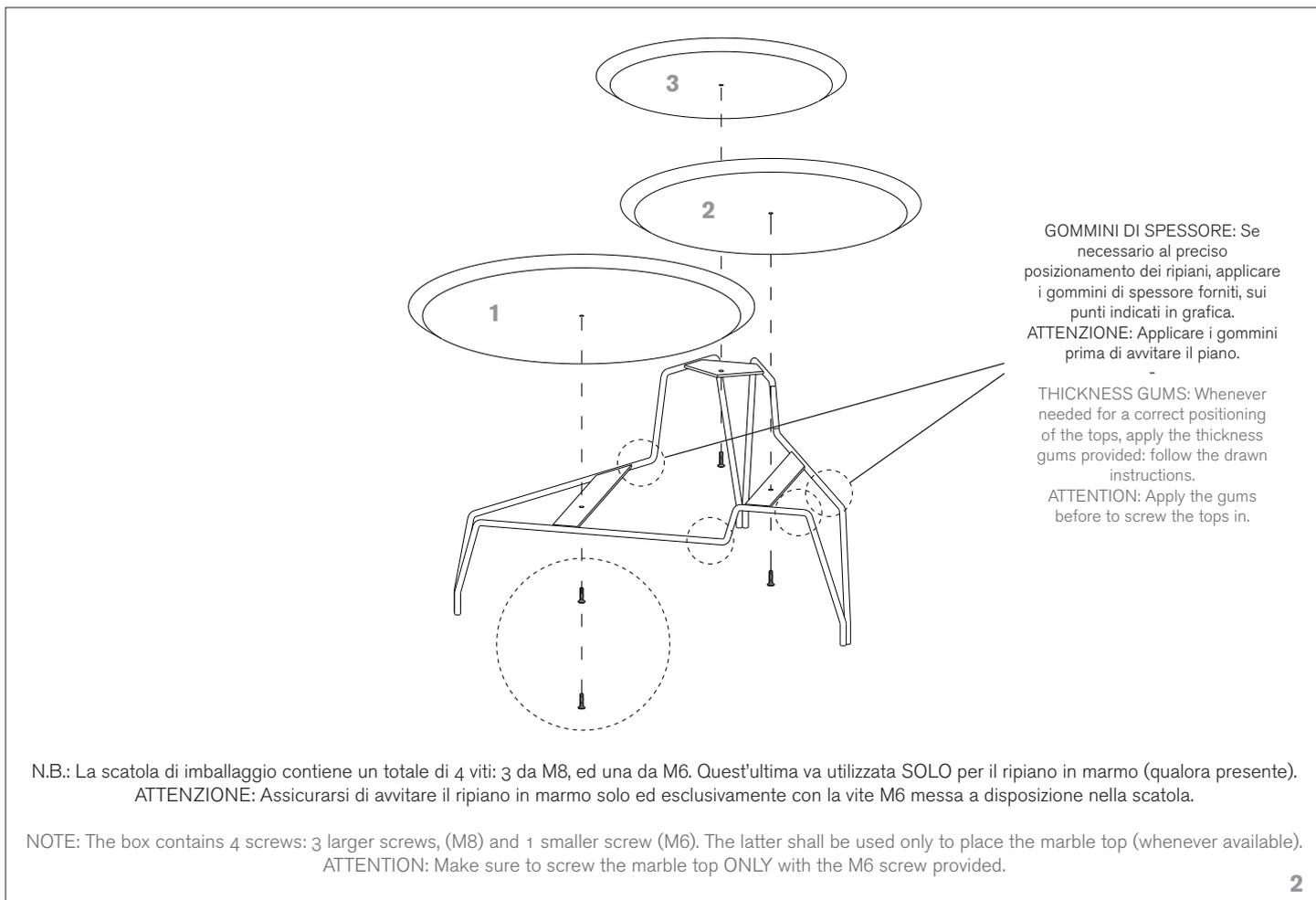
**GOMMINI DI SPESSORE:** Se necessario al preciso posizionamento dei ripiani, applicare i gommini di spessore forniti, sui punti indicati in grafica.
