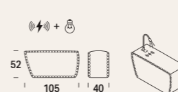
Bracciolo XL + carica batteria wireless + lampada touch XL armrest + wireless battery charger + touch lamp Accoudoir XL + recharge batteries sans fil + lampe touch Armlehne XL + kabelloses Batterieladegerät + lampe berühren
